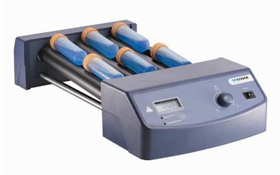
L'agitateur rotatif de tubes assure un mélange doux et efficace par rotation et balancement. Il est idéal pour le mélange d'échantillons sanguins, les substances visqueuses et des suspensions liquides-solides. Il est utilisé pour des applications diverses, la prévention de la coagulation sanguine, les séparations immunitaires, etc.
